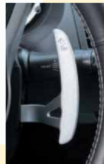
Pod volantem jsou dlouhé hoříčkové páčky. Pravou se řadí vstoupně, levou sestupně. GSR s manuálem je nemá.
