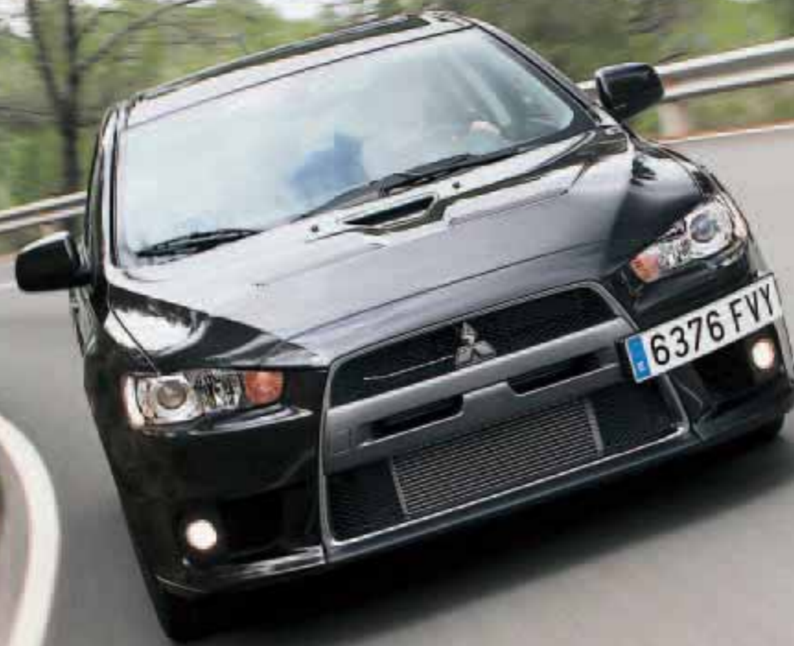
Lancer Evolution se proti předchůdci Evo IX natáhl o 15 mm (4505 mm), rozšířil o 40 mm (1810 mm) a narostl o 30 mm (1480 mm). Rozvor se prodloužil o 25 mm na konečných 2650 mm. Navzdory masivnímu použití hliníku (střecha, kapota aj.) vůz přibral 95 kilogramů (1560 kg).
