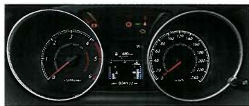
Dlouhozdvihový motor má poměrně nízké otáčkové maximum – jeho červené pole začíná brzy
